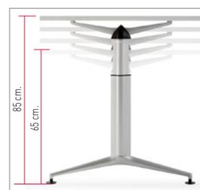
La regulación de altura de Trama, se realiza entre las posiciones de 65 cm en la posición más baja hasta 85 cm en la posición más alta, confiriéndole de esta manera una mayor operatividad. Esta regulación se produce en 10 posiciones distintas situadas cada 20 mm. Ajuste mediante nivelación de +10 mm
