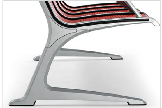
Pie integrado en estructura lateral, fabricado en aluminio inyectado a presión con nivelación de Polipropileno (P.P.) de color negro
